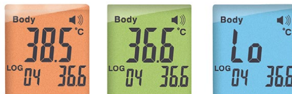
Индикация дисплея NB-401 в зависимости от температуры
