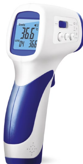
Индикация дисплея NB-401 в зависимости от температуры
